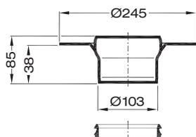
**Aufsatzelement mit Muffe**
